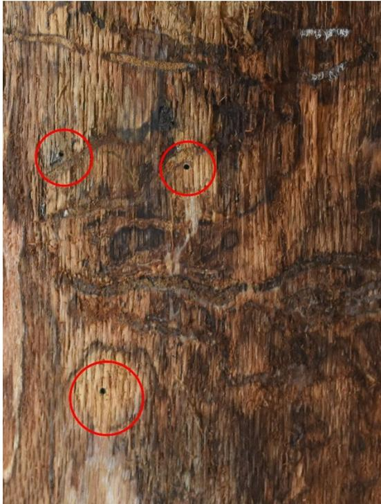
**Abb. 4:** Einbohrungen des Eichenkernkäfers und Larvengänge des Eichenprachtkäfers
